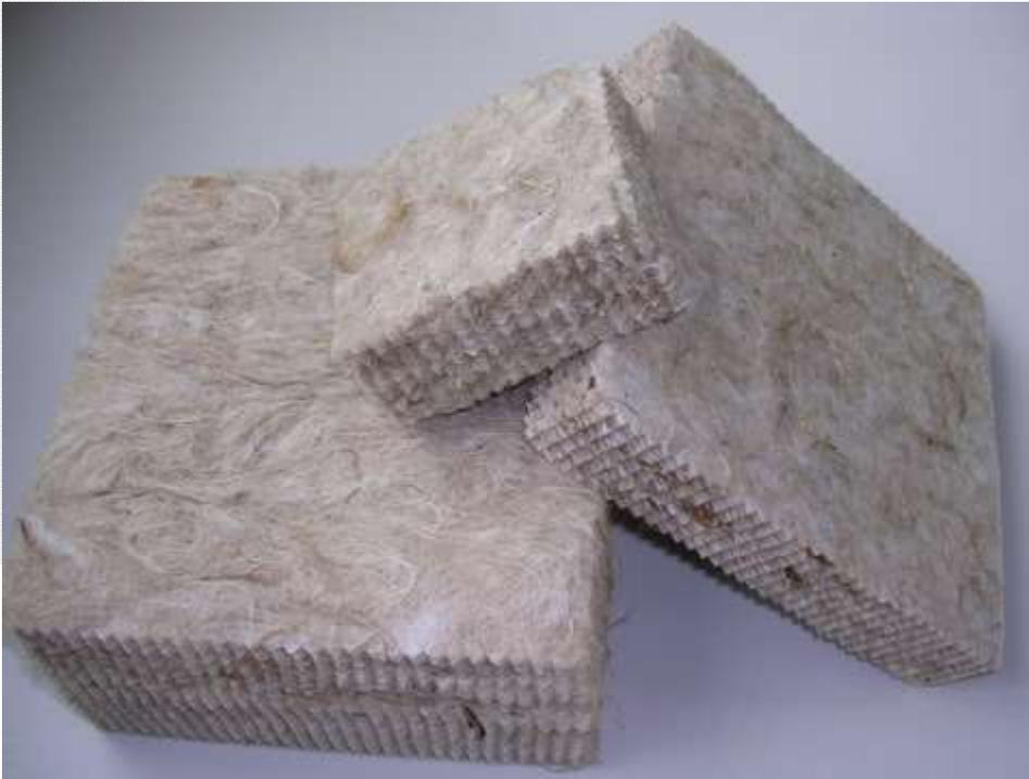
Materiale isolante a base di fibre di kenaf intrecciate, non agugliate ma termofissate tridimensionalmente a cui viene aggiunta una minima parte di fibra di rinforzo in poliestere. Le fibre di kenaf provengono dalla corteccia e dal legno dell' **Hibiscus cannabinus** pianta di origine asiatica ma coltivata oggi anche in Italia.
